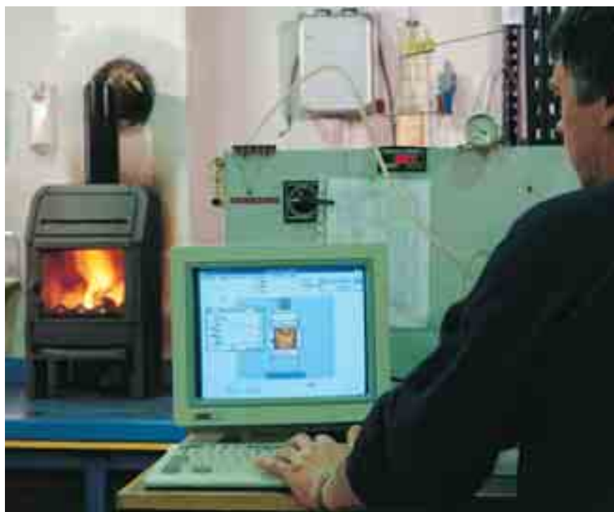
Fra laboratoriet. Her gjennomføres blant annet testing av produktenes forbrenning, utslipp og effekt.
